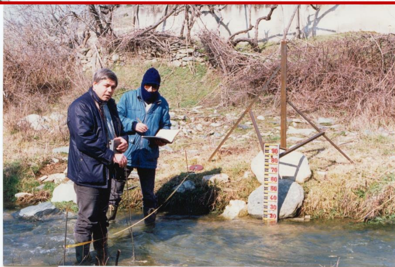
ΑΝΑΓΝΩΡΙΣΤΙΚΗ ΜΕΛΕΤΗ ΦΡΑΓΜΑΤΟΣ ΛΙΒΑΔΙΟΥ (ΜΕΤΡΗΣΗ ΠΑΡΟΧΗΣ ΜΕ ΜΥΛΙΣΚΟ)
