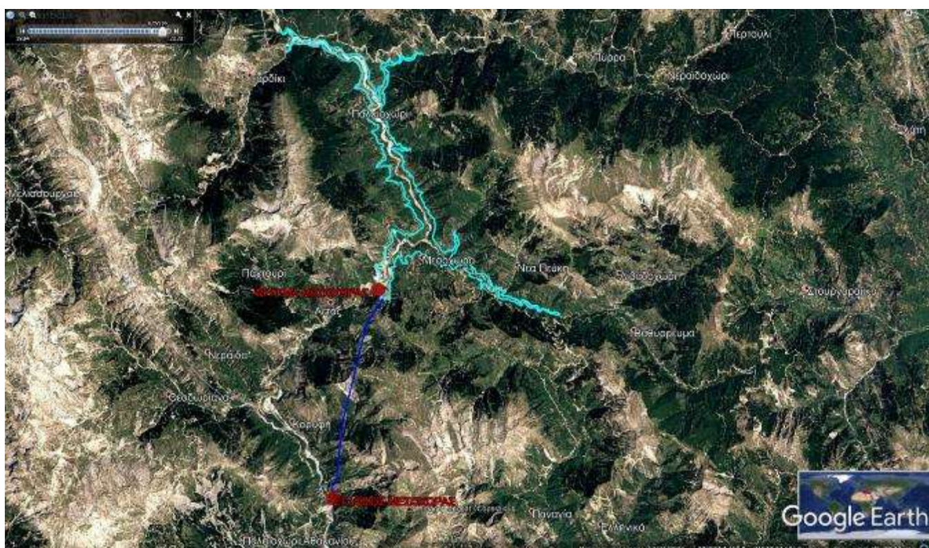
Σχήμα 1.1: Απόσπασμα δορυφορικής απεικόνισης (google earth), όπου με γαλάζια γραμμή απεικονίζεται η λεκάνη κατάκλυσης του φράγματος, με κόκκινα σημεία οι θέσεις του φράγματος και του ΥΗΣ και με μπλε γραμμή η σήραγγα προσαγωγής του ύδατος.
