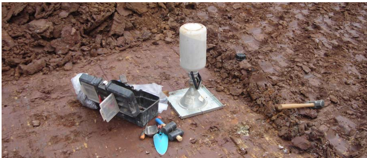
Φωτ. 18. Επί τόπου μέτρηση της πυκνότητας του πυρήνα με τη μέθοδο κώνου της άμμου.
